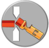
借助CQM II, 不良压接切断功能可立即检测到出现不良压接件, 并切断已压接的端子, 从而避免不良压接件意外传送到线束制造的下一道工序。不良
