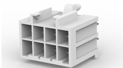
板端塑壳的金属脚尾部扭结和定位柱独特设计确保焊接过程中板端塑壳固定于 PCB 板上。板端塑壳可应用于线路板灌胶, 无排水孔。
