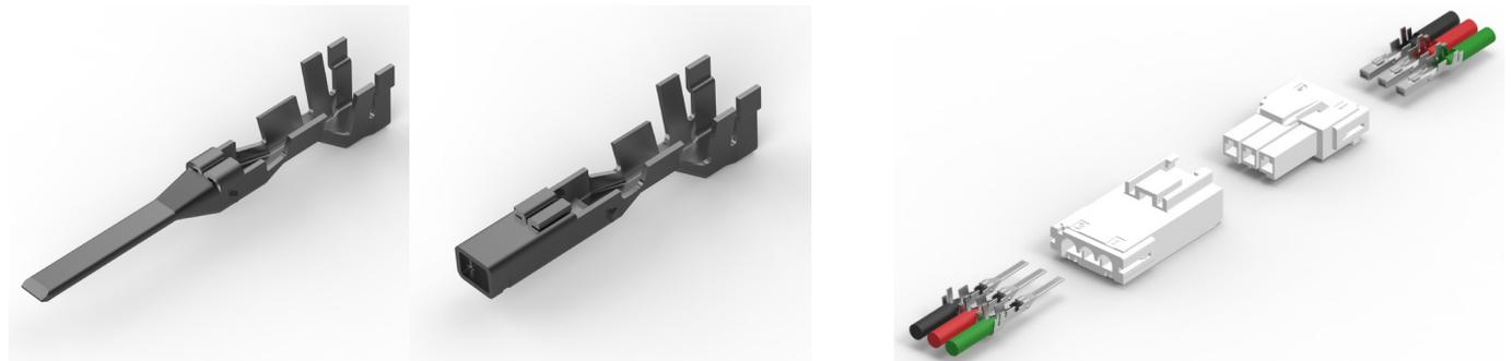
该 PDL 金属端子采用带预镀锡层磷青铜，无倒刺设计，以防止互相接触时出现缠绕。母端子安装于母端塑壳，公端子安装于公端塑壳。
